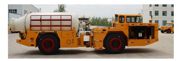
Подземная самоходная машина для доставки бетонной смеси 5 m³ XGBULL XGJC-5 (с горизонтным баком)
